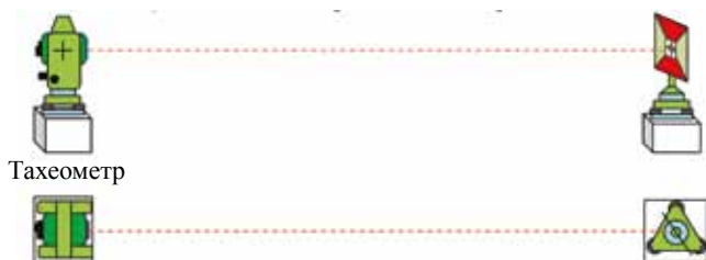
Рис. 2. Исследования точности работы лазерного дальномера
