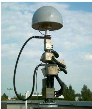
Рис. 4. Робот, выполняющий калибровки антенн (Geo++)
