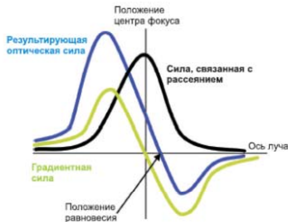
Рис. 1. Сложение силы, связанной с рассеянием излучения и градиентной силой при оптическом захвате микрообъекта [10]. Черная линия – сила, связанная с рассеянием излучения, в зависимости от смещения захваченного микрообъекта относительно оси лазерного пучка. Зеленая линия – градиентная сила. Синяя линия – результирующая градиентной силы и силы, связанной с рассеянием лазерного излучения
